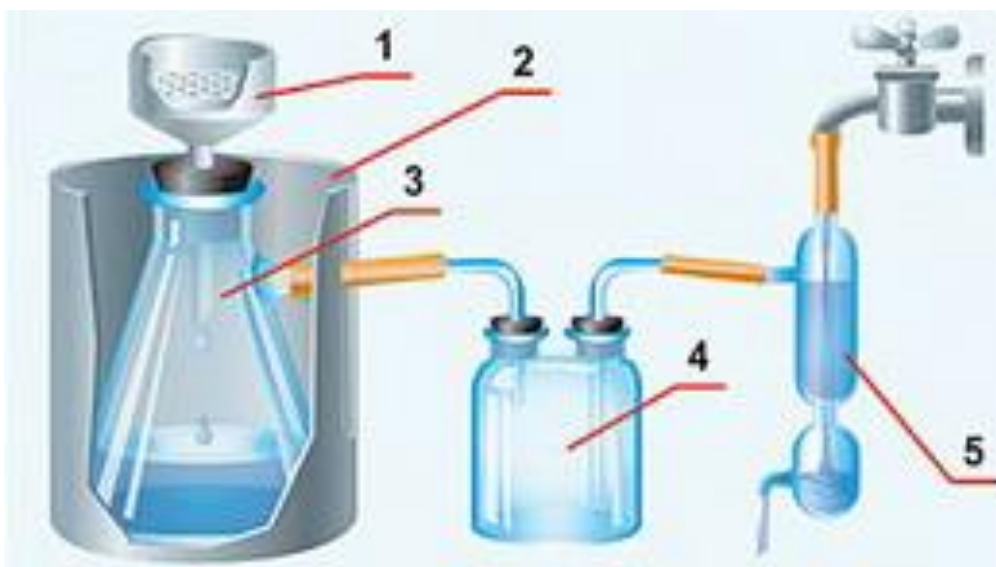
14-сурет. Вакуумде сүзу: 1-Бюхнер құйғышы, 2- сақтаушы қаптама, 3-Бунзер колбасы, 4-сақтаушы шыны ыдысы, 5-су ағынды насос
